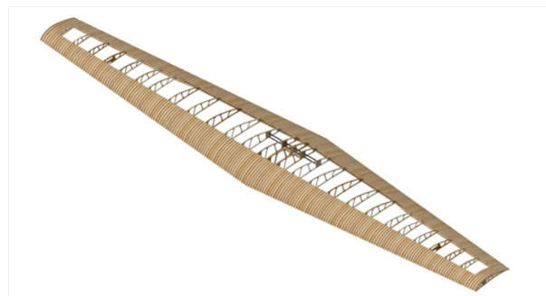
Figura 5.2: Detalhe da asa em software CAD - projeto “BRUTO” da equipe Poliacrive de Aerodesign 2008.
